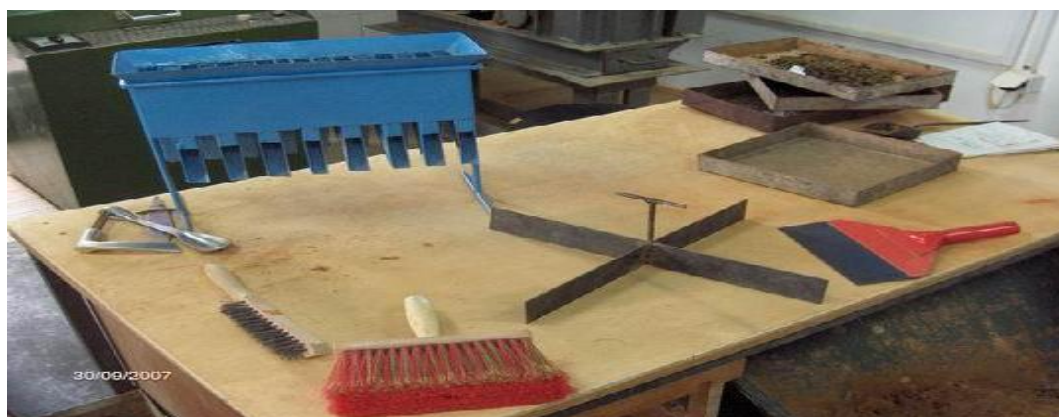
Слика 51. Прибор за квартаирање на издробените проби Picture 51. Tools for quartering of crushed samples
