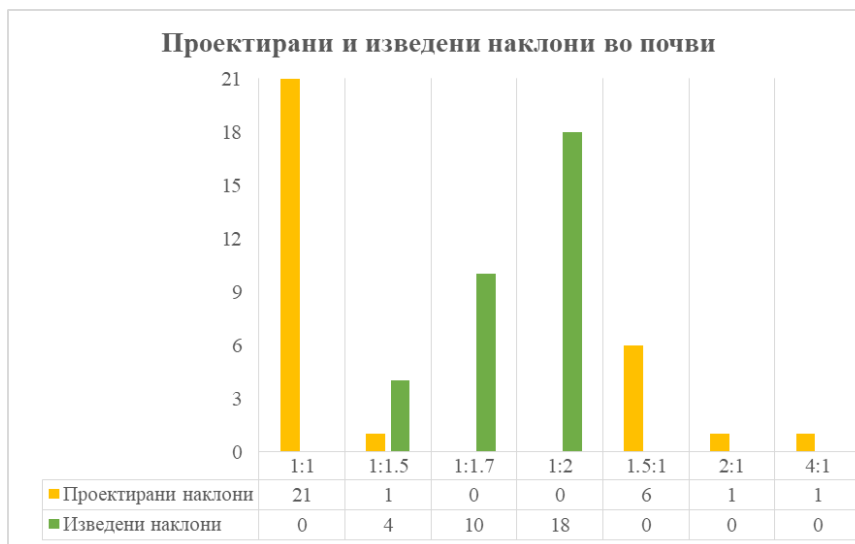
Слика 3. Преглед на проектирани и изведени наклони на косини во почви.
