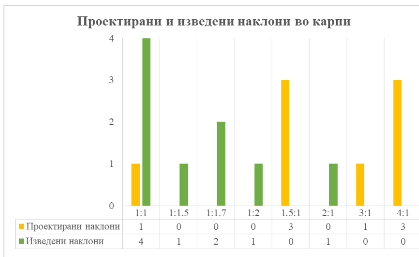
Слика 3. Преглед на проектирани и изведени наклони на косини во карпи.
