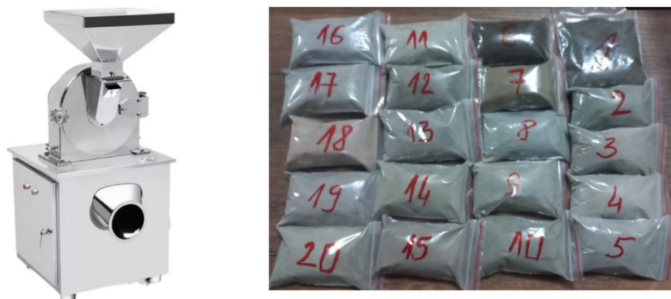
Слика 16. Мелница со пин Јан што се користи за мелење примероци; (б) примероци од прав по хомогенизација со тежина од 10 g, подготвени за испорака во лабораторија Figure 16. (a) Pin Yan mill used for grinding rock samples to fine granulometry prior to mineralogical and geochemical analyses; (b) representative powdered samples (Samples 1-20) after homogenization and weighing to 10 g, prepared for submission to laboratory analysis.
