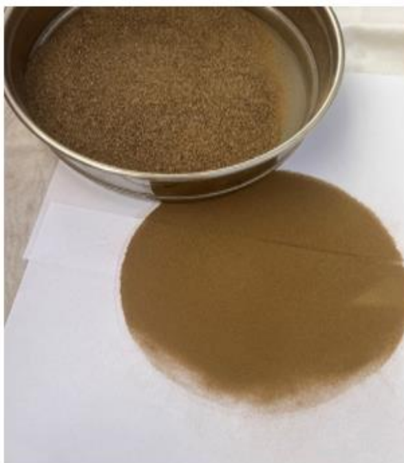
Слика 8. Собирање и просејување на примероци од исушен талог
