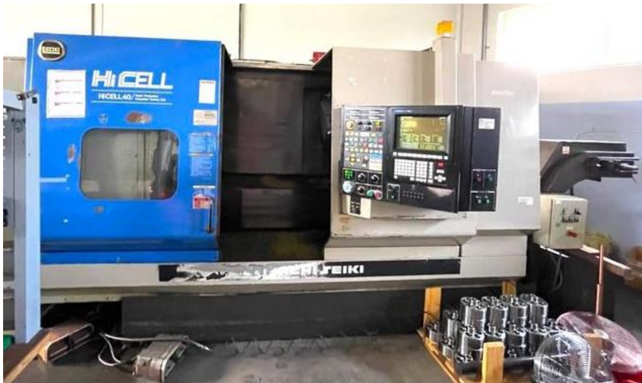
Слика 17: CNC Hitachi Seiki Seicos LIII струг Figure 17: CNC Hitachi Seiki Seicos LIII lathe machine
