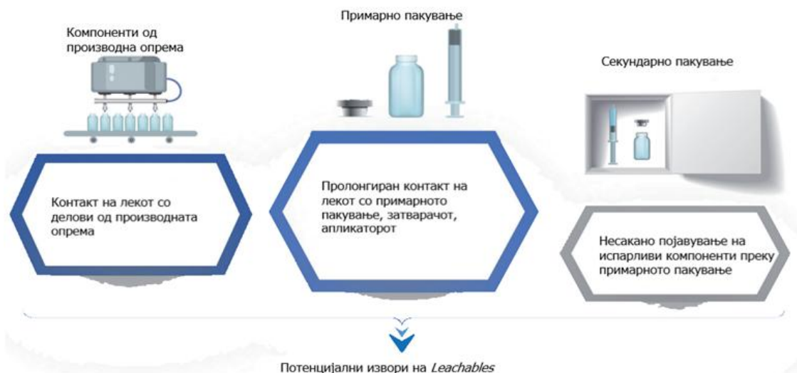
Слика 5. Извори на потенцијални Leachables вклучуваат производни компоненти во контакт со лекот за време на производството, примарното пакување, системите за затворање и секундарното пакување ( https://www.ondrugdelivery.com/exploring-extractable-and-leachable-testing-strategies-for-parenterals/ )
