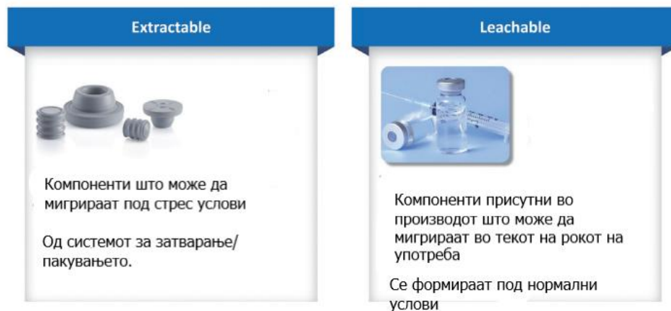
Слика 4. Extractables се соединенија што би можеле да мигрираат во производот; Leachables се соединенија кои мигрираат во производот под репрезентативни услови ( https://www.ondrugdelivery.com/exploring-extractable-and-leachable-testing-strategies-for-parenterals/ )
