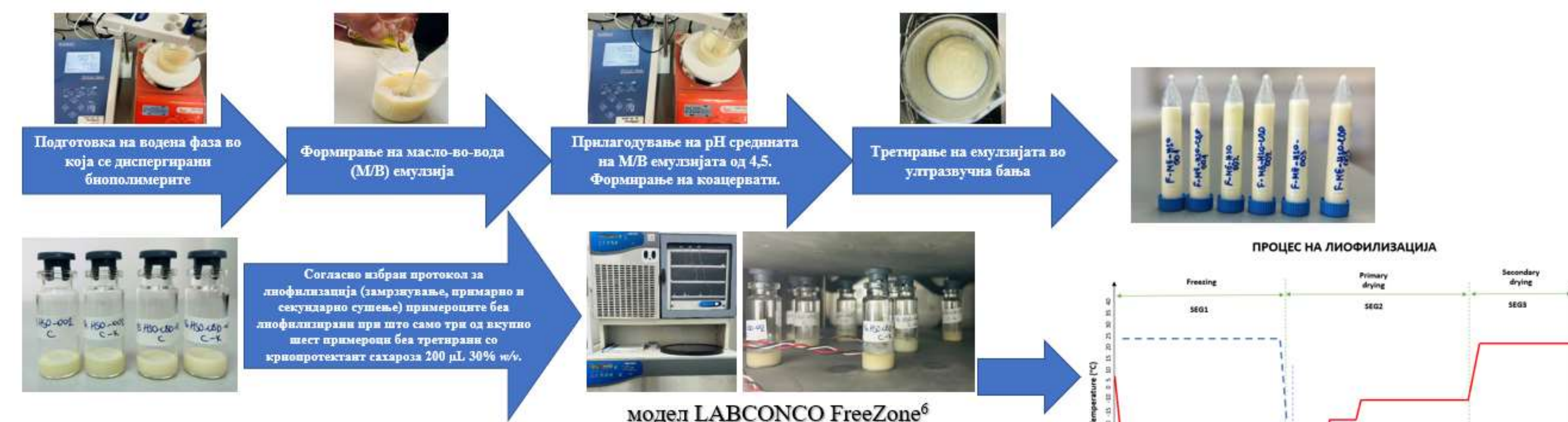
Слика 2. Шематски приказ на фази во производството на лиофилизирани микрочестички со CBD.
