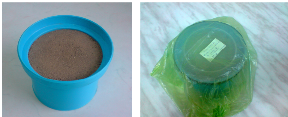
Слика 3-4. Сад и геометрија на мерење: Marinelli 500ml
