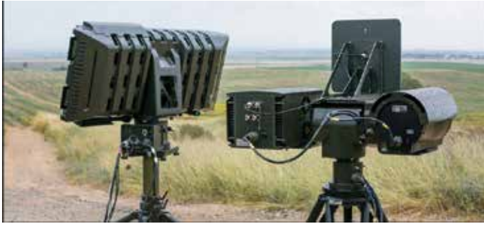
Слика 2. Модел „MC-HORIZON II 360E“ – прикажува стационарен попречувач, кој овозможува заштита на поширока област
