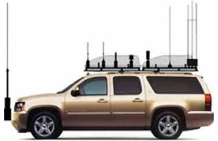
Слика 5. Возило со RCIED-попречувач – прикажува воено возило опремено со попречувач
