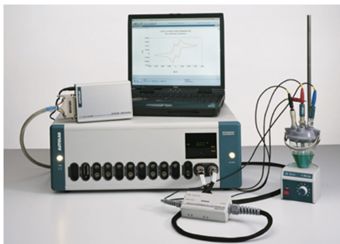
Сл. 6. Приказ на еден интегриран електрохемиски систем, каде потенциостатот е поврзан со електрохемиска ќелија и со персонален компјутер
