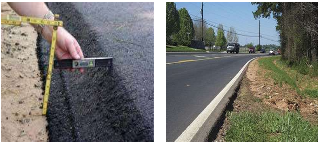
Слика 112: Проверка на слегнување на банкните
