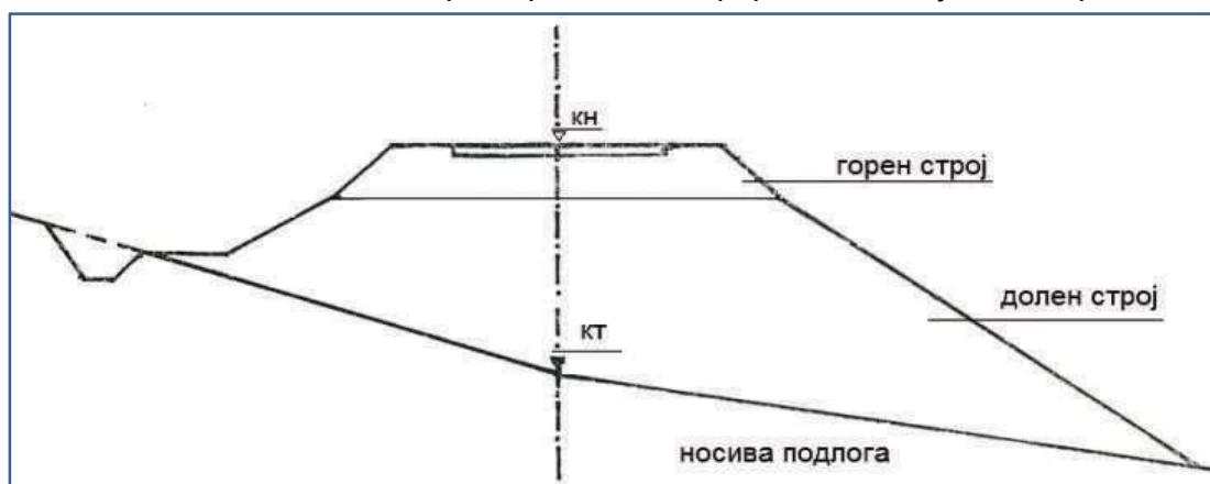
Слика 26: Геотехничките работи за градење долен строј
