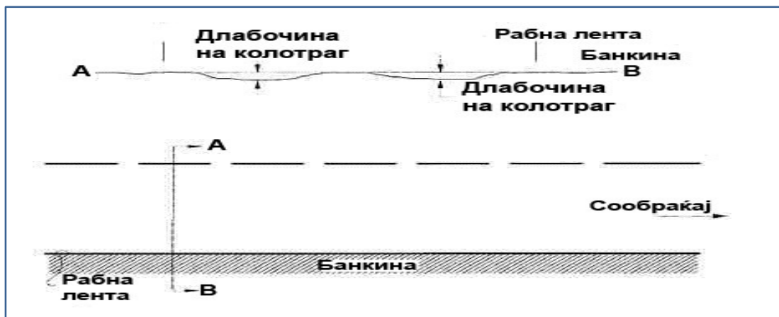
Слика 107: Мерење на длабочина на колотрагот
