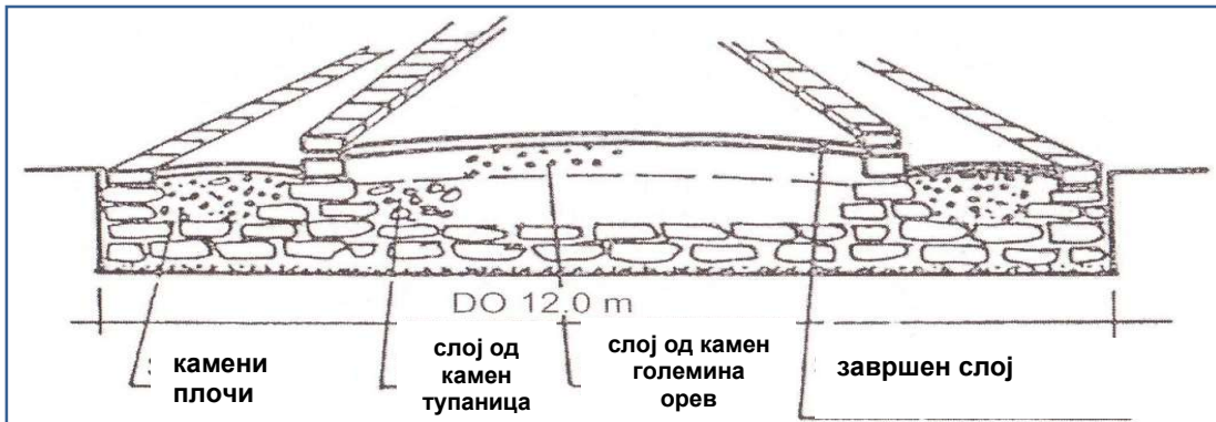
Слика 51: Попречен пресек на римски државен пат
