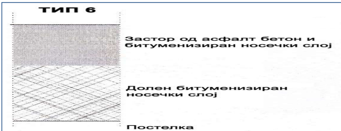
Слика 57: Флексибилна коловозна конструкција ТИП 6
