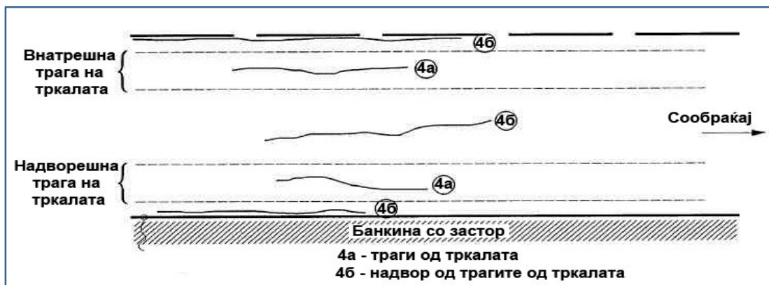
Слика 80: Надолжни пукнатини
