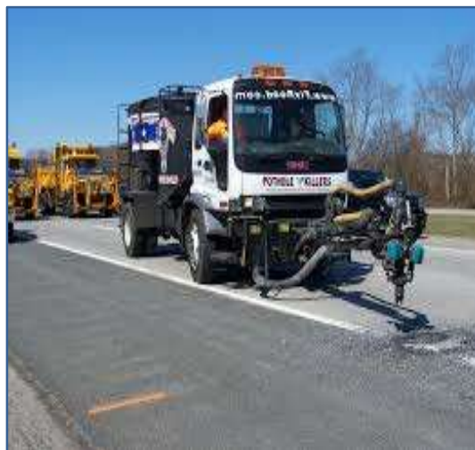
Слика 100: Поставување на материјал во дупката со вбризување односно инјектирање
