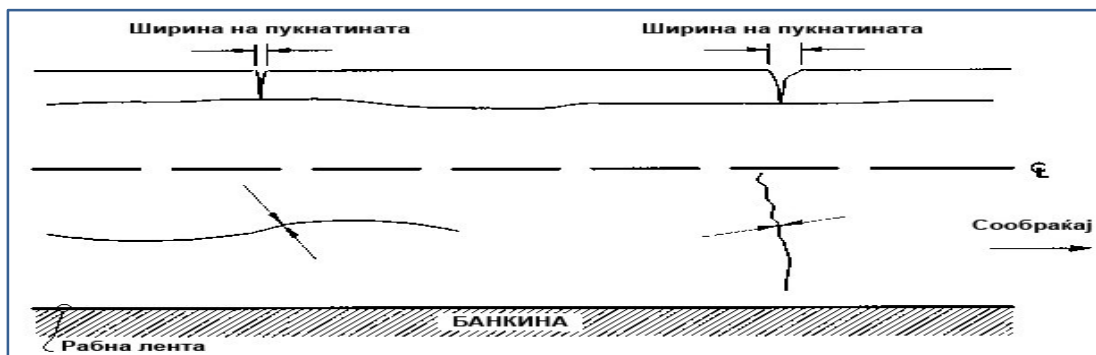
Слика 71: Мерење на ширината на пукнатини кај асфалт бетонските коловози
