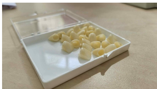
Слика 7. Изработени примероци од цирконија со наслојувана керамика
