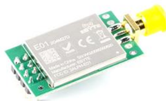
б) NRF24L01 E01-ML01DP5 модул
