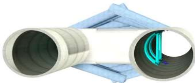
Слика 3. Замрзнат попречен премин CP-23
