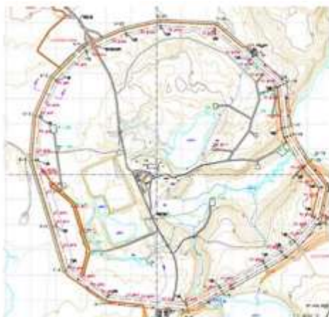
Слика 6. Систем за замрзнување на земјата во рудникот Aquarius
