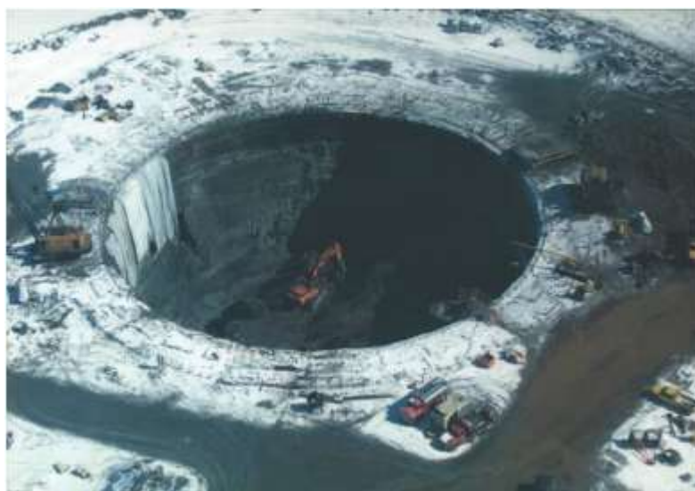
Слика 5. Процес на ископување на рудното тело со форма на столб
