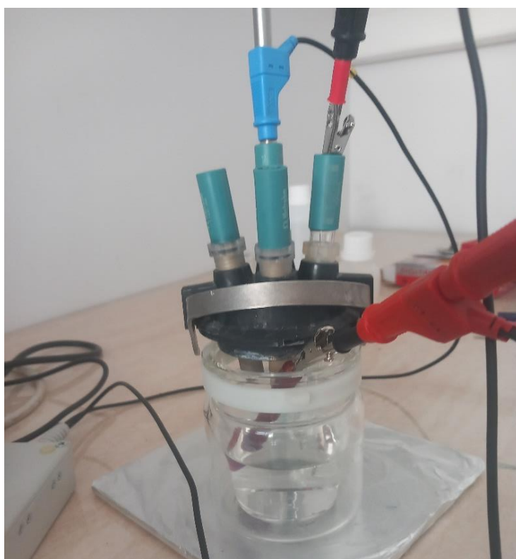
Слика S46. Приказ на електрохемиска ќелија во која беа изведувани волтаметриските експерименти.
