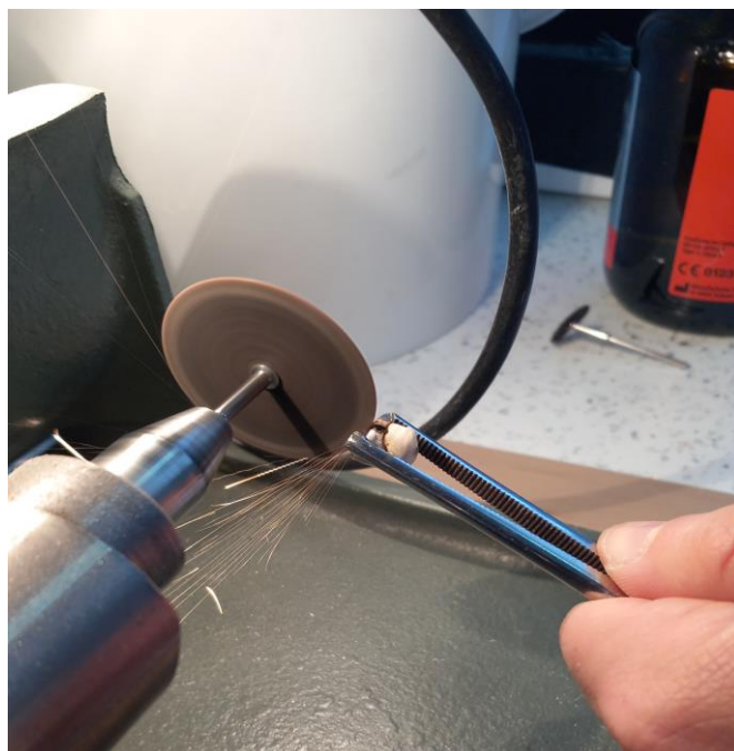
Слика S40. Добивање на пресек од оштетена телескоп коронка. Figure S40. Obtaining a cross-section of a damaged telescope crown.
