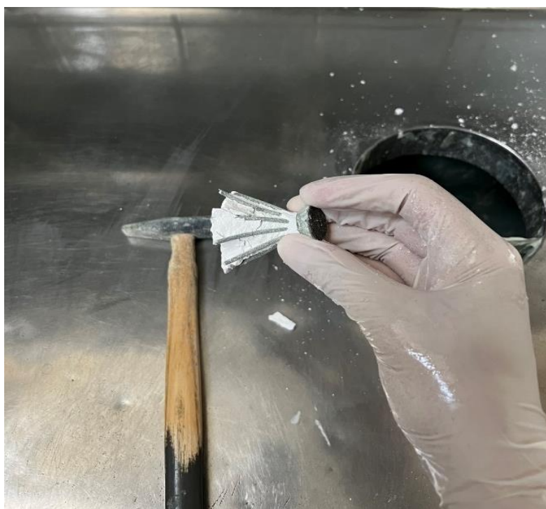
Слика S22. Отворање на киветата после леењето и отстранување на огноотпорната маса. Figure S22. Opening the cuvette after casting and removing the refractory mass.
