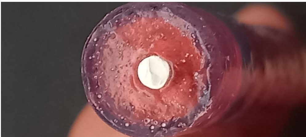
Слика S28. Дел од референтна електрода кој е во контакт со супстратот за изведување на електрохемиска анализа.
