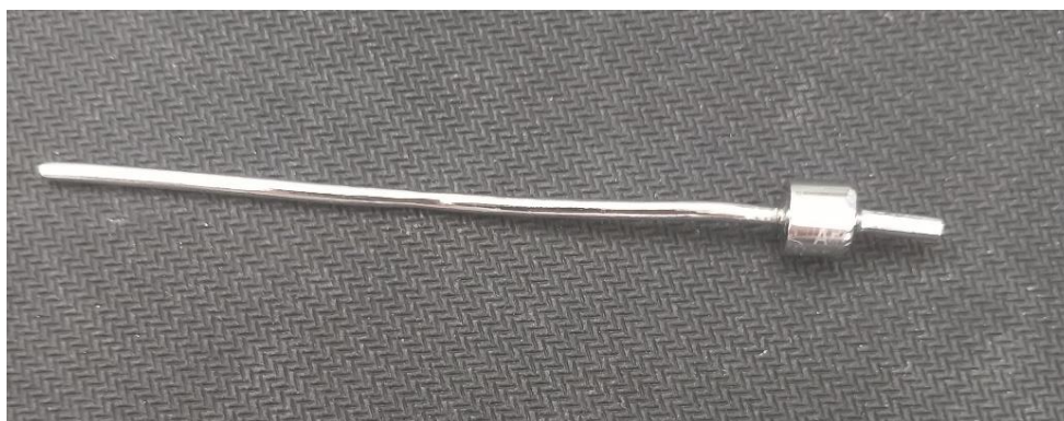
Слика S26. Метален дел од референтна легура за добивање на електрода за електрохемиска анализа.
