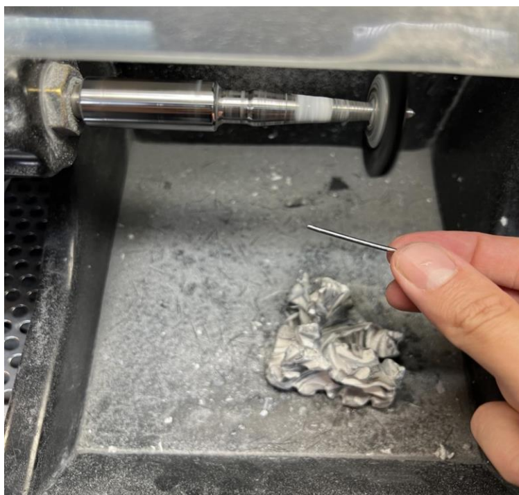
Слика S23. Обработка и полирање на металниот штифт од кој е изработена електродата.
