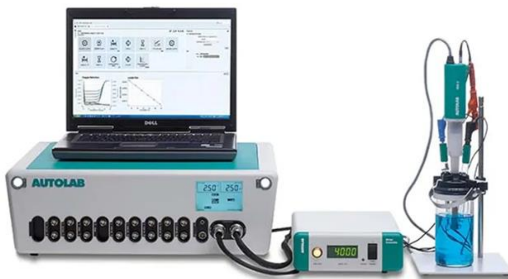
Слика 3. Приказ на електрохемиски систем што се користи во волтаметриските експерименти.
