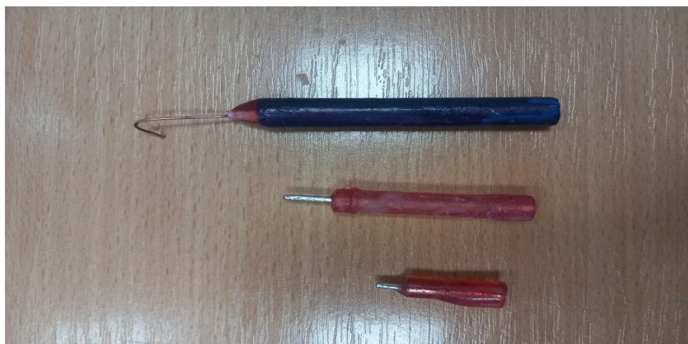
Слика S29. Електроди од: референтна легура, излеан штифт и оштетен телескоп за изведување на електрохемиска анализа.
