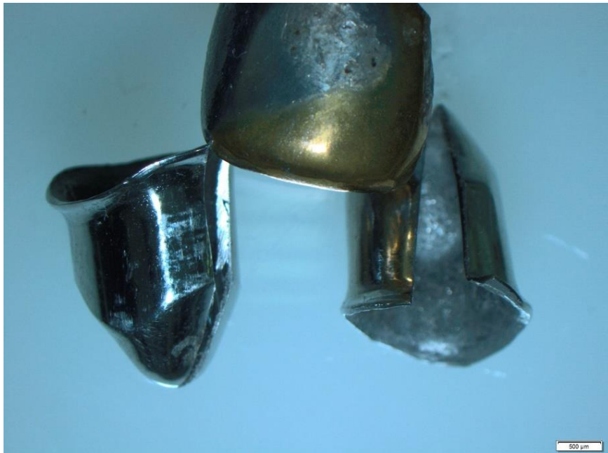
Слика S37. Приказ на неоштетени и оштетени внатрешени телескопи. Figure S37. Scheme of undamaged and damaged internal telescopes.
