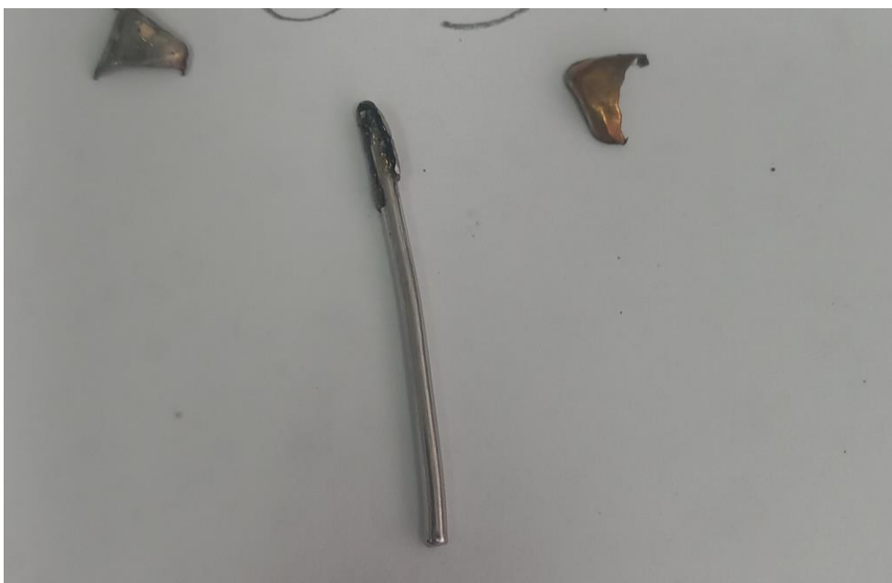
Слика S43. Поставување на метален фрагмент од оштетен внатрешен телескоп коронка на сонда за добивање на електрода. Figure S43. Placing a metal fragment from a damaged inner telescope crown on a probe to obtain an electrode.
