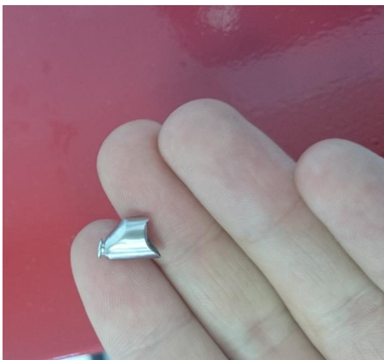
Слика S33. Внатрешен телескоп излеан и обработен во метал. Figure S33. An internal telescope cast and machined in metal.
