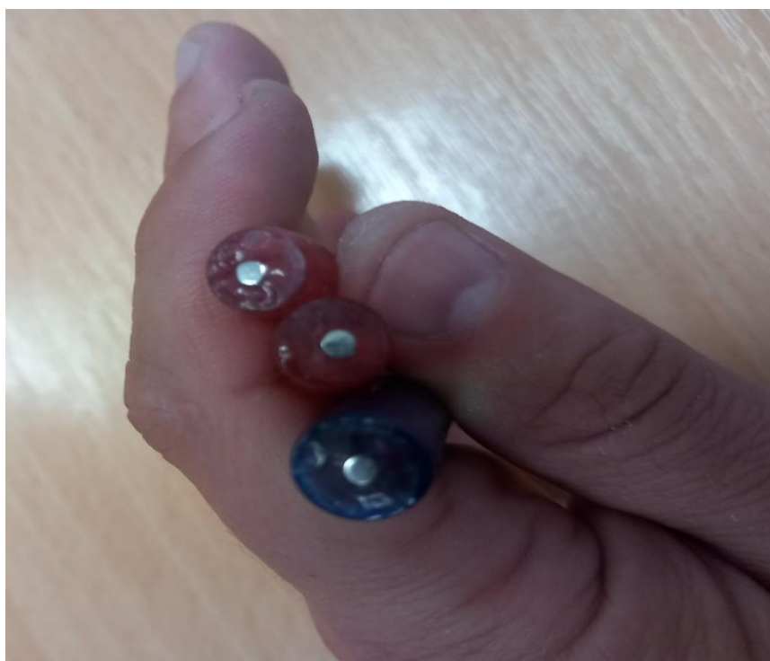
Слика S30. Дел од референтна електрода, излеан штифт и оштетен телескоп кој е во контакт со супстратот за изведување на електрохемиска анализа.
