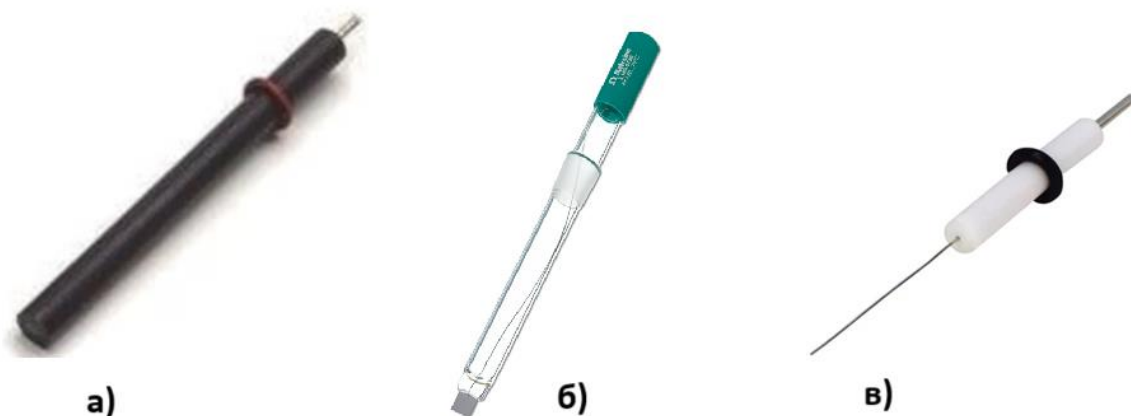
Слика 2. Дизајн на работна (а), референтна (б) и помошна електрода (в) што се употребуваат во волтаметриските техники.
