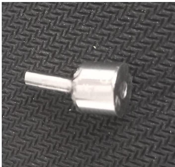
Слика S25. Фрезувана референтна легура за добивање на електрода.
