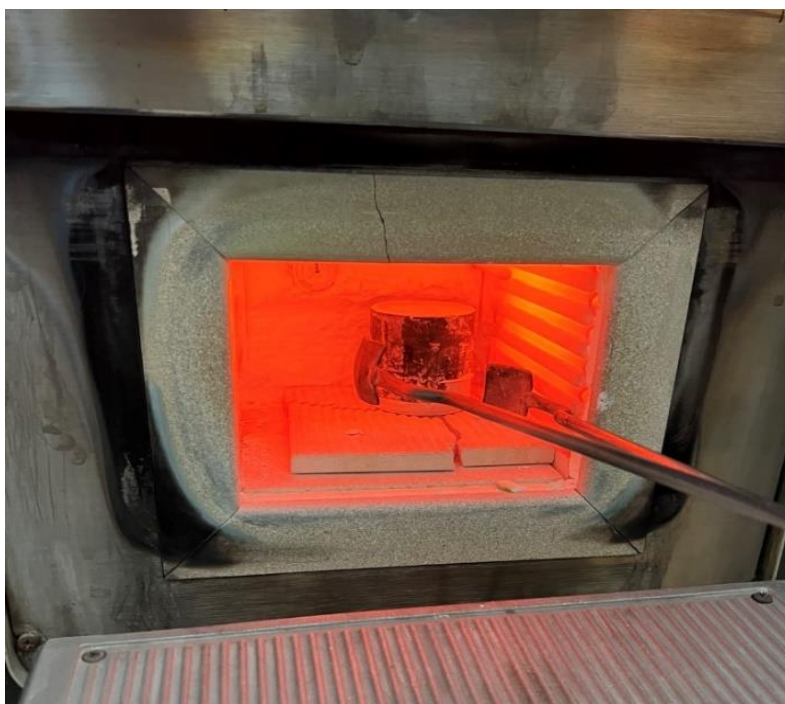
Слика S21. Поставување на вложената кивета во печка за жарење. Figure S21. Placing the embedded cuvette in the annealing furnace.
