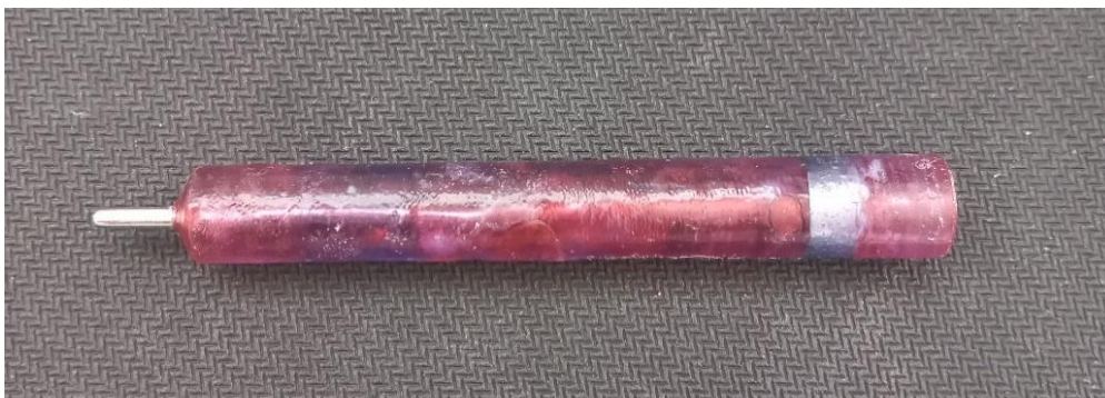
Слика S27. Електрода од референтна легура за изведување на електрохемиска анализа.
