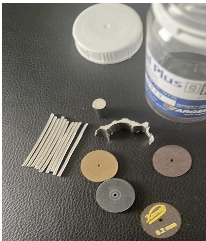
Слика S24. Примероци од референтната легура и метални штифтови по леењето.
