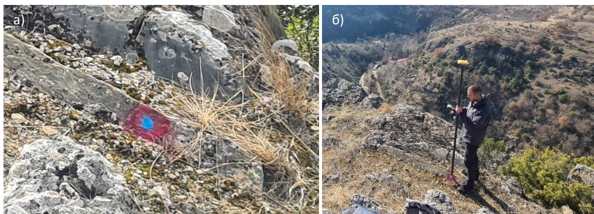
Слика 74 а) референтна точка б) снимање со ГПС-уред
