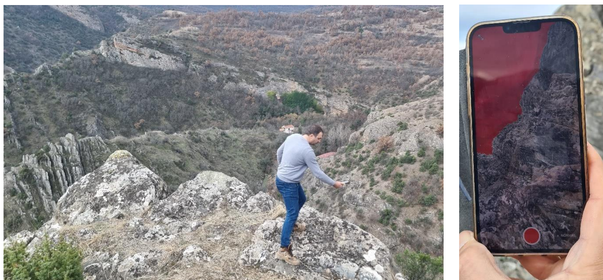
Слика 75 LiDAR-снимање со употреба на паметен телефон на локалитет Фариш
