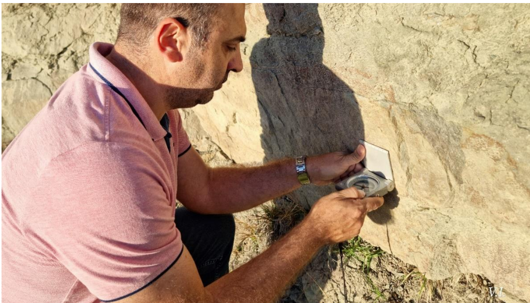
Слика 98 Мерење со геолошки компас на локалитетот Серта Figure 98 Measurement using geological compass at Serta site
