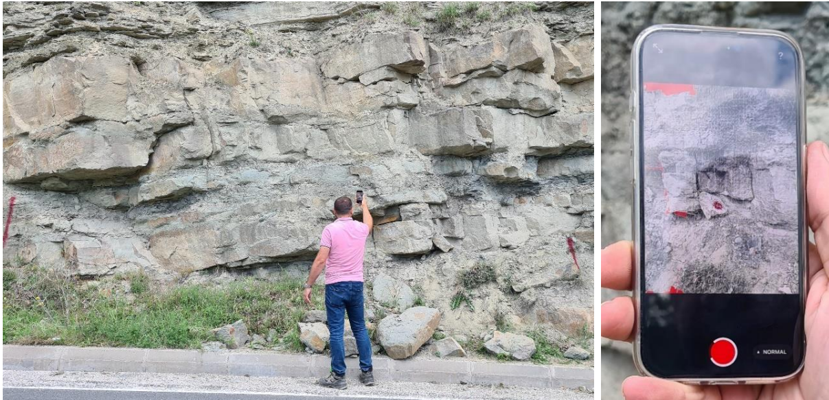
Слика 99 LiDAR снимање со паметен телефон на локалитетот Серта
