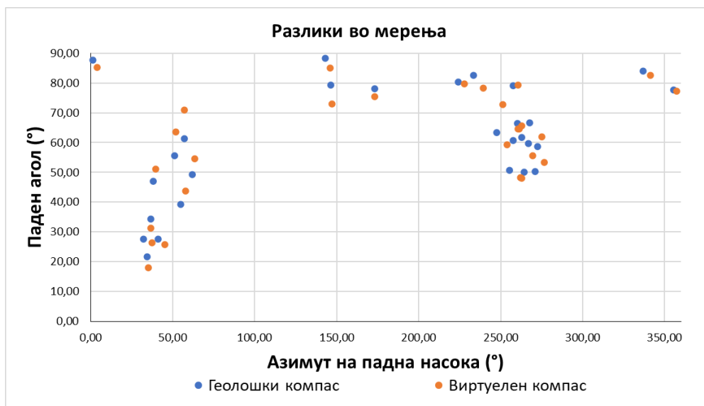
Слика 81 Приказ на групи на мерења со геолошки компас (сино) и виртуелен компас (портакалово).
