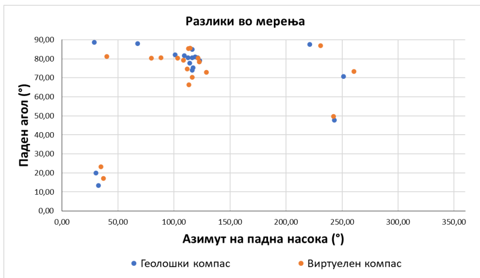
Слика 105 Приказ на групи на мерења со геолошки компас (сино) и виртуелен компас (портокалово)
