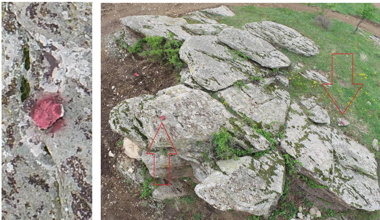
Слика 31 Маркери за геореферентни точки со црвена боја Figure 31 Red markers for points for georeferencing
