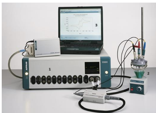
Слика 3. Приказ на електрохемиски систем што се состои од потенциостат (1) поврзан со електрохемиска ќелија (2) и компјутер (3).
