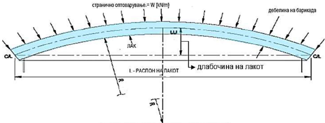
Слика 2. Поедноставен модел на лак изложен на притисок за барикади од прскан бетон (приказ на план) [2] [5]
