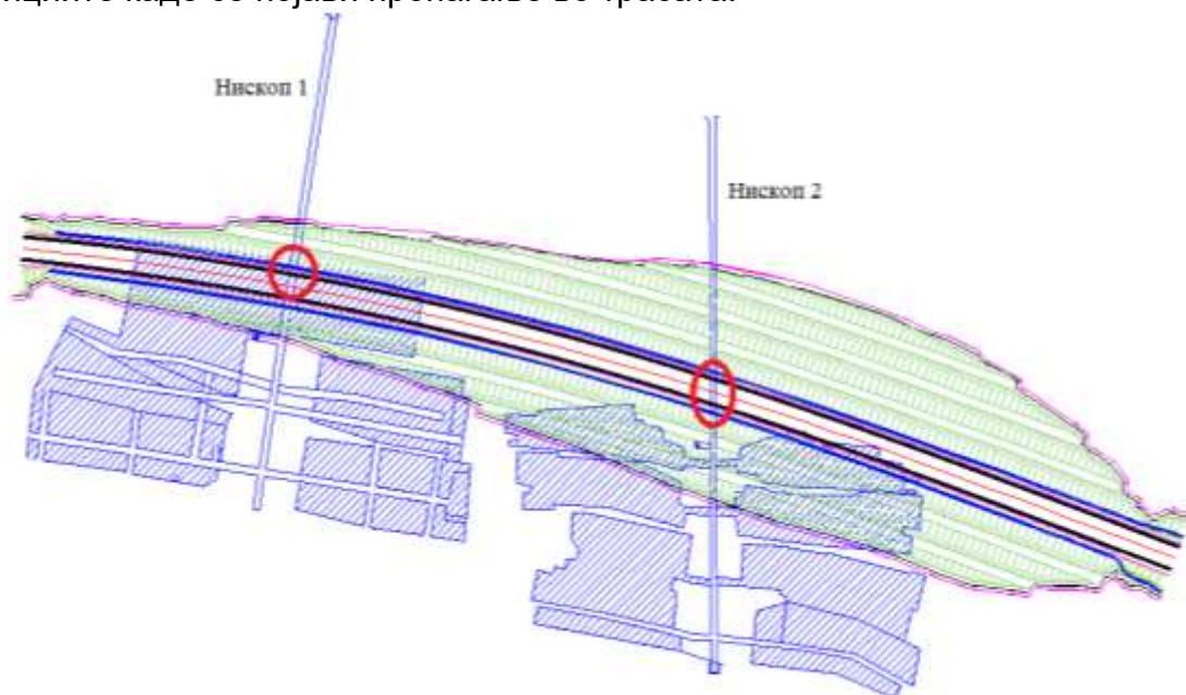
Слика 1. Поставеност на подземните рударски работи-нископи и галерии (со сина боја) во однос на протегање на трасата (карта од 1998 год. геореференцирана од И. Ивановски)
