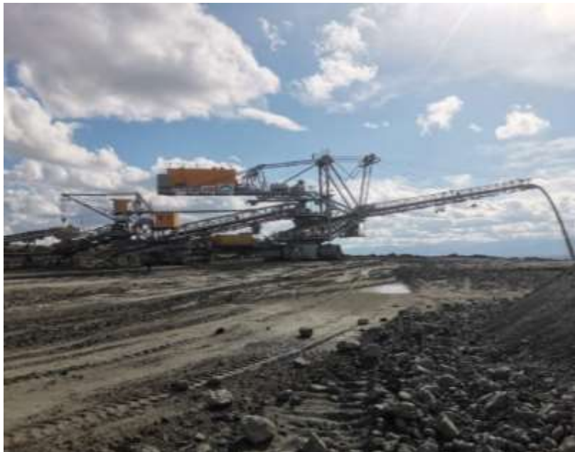
Слика 8. Приказ на одлагачот A2RsB 5500 x 60 во позиција на длабинско одлагање
