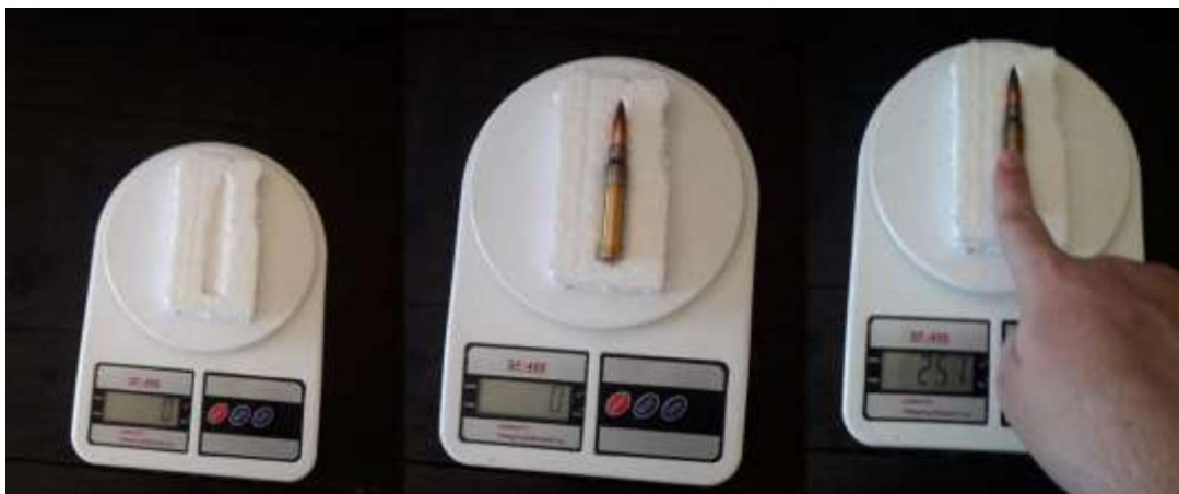
Слика П2. Нанесување на отпечатоци со избрана маса.
