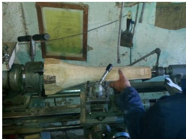
Фотографија 10. Делумно изработен корпус на зурлата јарам-каба, подготвен за надворешно обработување на дребанг.
