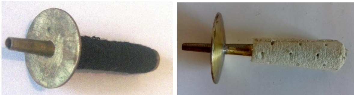
Фотографија 19. Медник завиткан со конец и медник завиткан со плута.
