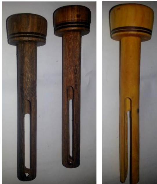
Фоторграфија 15. Делумно изработен славец од орев без одвоени краци (лево) и подготвен славец од зеленика (десно), изработени од Вецко Стојкоски.
