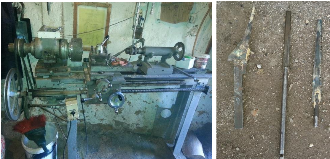
Фотографија 6. Дребанг (лево) и алат изработен од Вецко Стојкоски, за внатрешно одземање на корпусот (десно).
