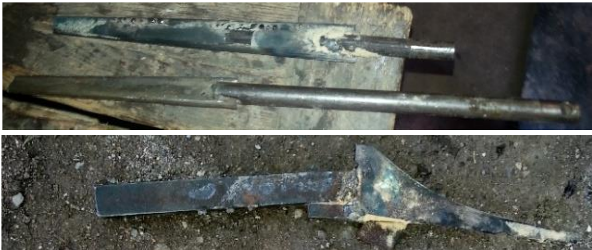
Фотографија 11. Алатки изработени од Вецко Крстевски (лево – за внатрешно одземање на корпусот, десно – за внатрешно одземање на шапката).
