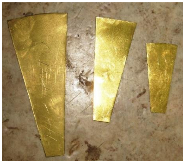
Фотографија 16. Шаблони за медник во различни димензии, изработени од Раде Ложанкоски.
