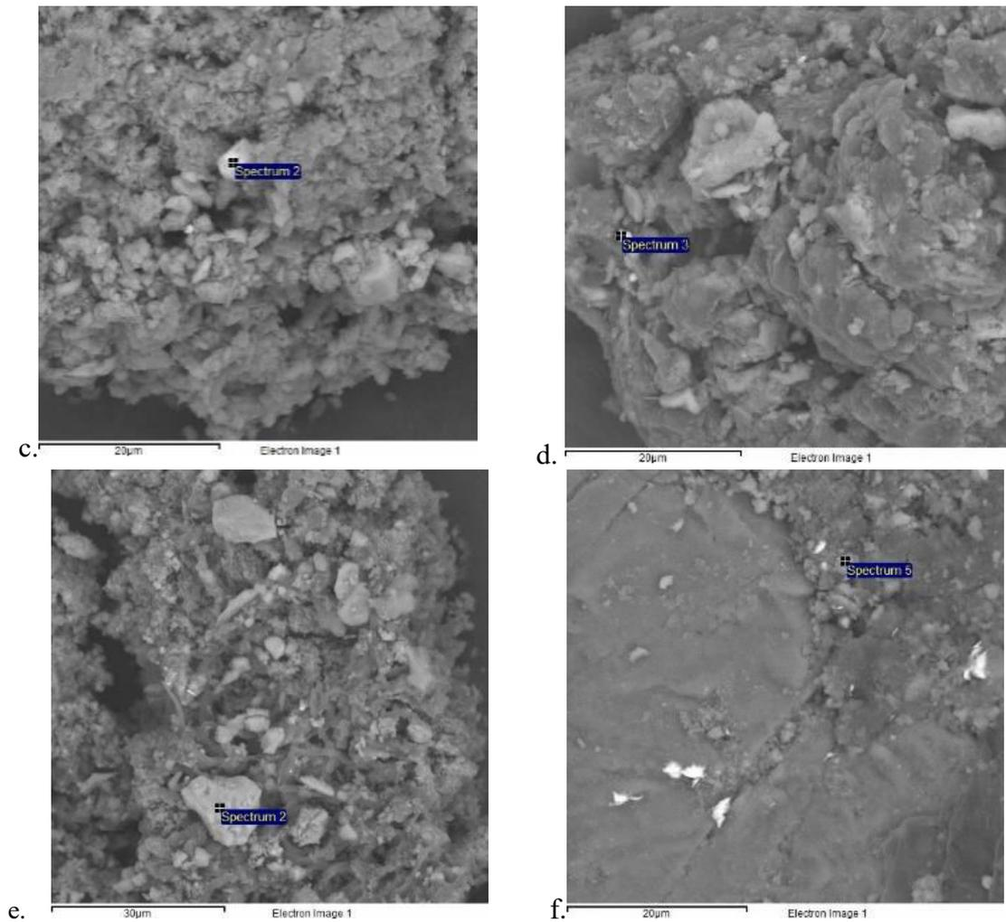
Figure 5. The SEM microscopic images of: a) calcite; b) dolomite; c) Fe, Al silicate; d) Fe carbonate; e) Ca, Fe, Al silicate; f) Ca silicate
