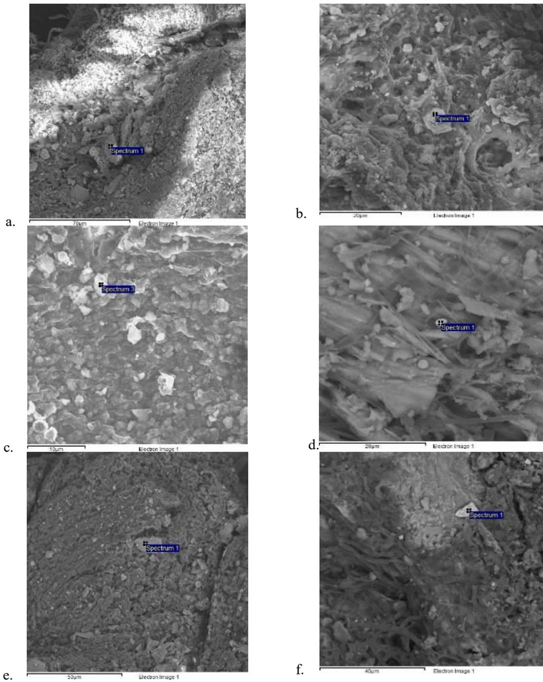
Figure 3. The SEM microscopic images on: a) Na, Al silicate; b) quartz; c) calcite; d) Fe, Mg silicate; e) Al silicate; f) Fe oxide
