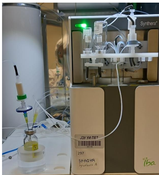
Слика 13. Монтирана касета со прикачени реагенси и кертриџи Figure 13. IFP cassette with attached reagent and cartridge
