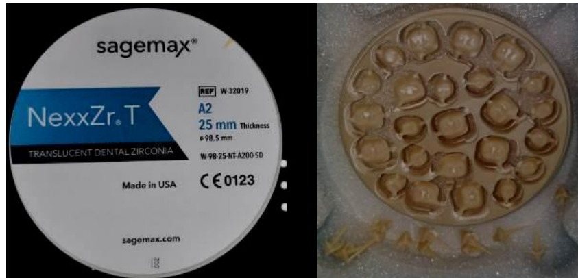
Слика 20. Zirconia CAD/CAM блок CAD/CAM disc и надградби изработени од Zirconia со CAD/CAM технологија Figure 20. Zirconia CAD/CAM block CAD/CAM disc and posts made of Zirconia with CAD/CAM technology
