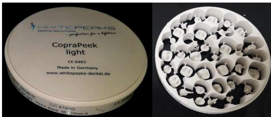
Слика 21. ПЕЕК CAD/CAM disc и надградби изработени од ПЕЕК материјал со CAD/CAM технологија Figure 21. PEEK CAD/CAM disc and extensions made of PEEK material with CAD/CAM technology
