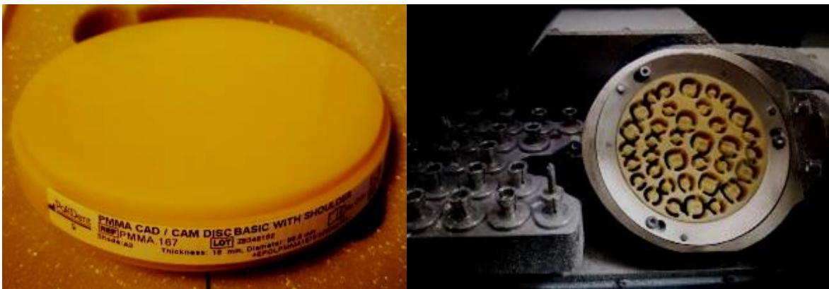
Слика 19. ПММА CAD/CAM disc и надградби изработени од ПММА акрилатен материјал со CAD/CAM технологија Figure 19. PMMA CAD/CAM disc and restorations made of PMMA acrylate material with CAD/CAM technology
