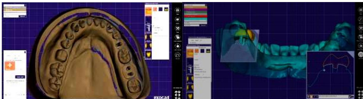
Слика 7. Постапка на суперпонирање на скенираниот мастер модел со лабораториски скенер со скенираниот мастер модел со интраорален скенер Figure 7. Procedure of superimposing the master model scanned by the laboratory scanner with the master model scanned by the intraoral scanner
