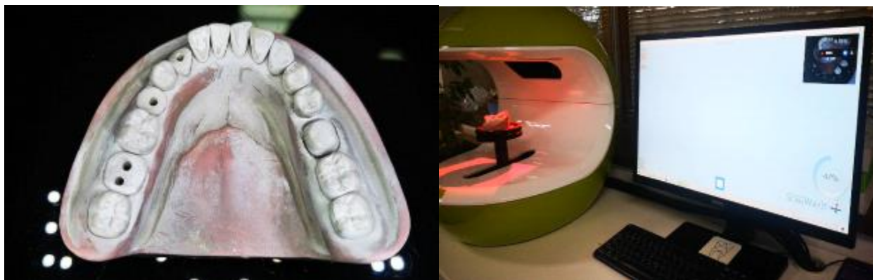
Слика 2. Мастер модел и скенирање со 3-Д оптички лабораториски скенер (NeWay, Open Technologies, Rezzato, Italy)
