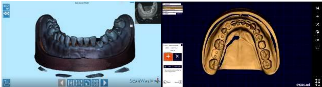
Слика 3. Виртуелен работен модел добиен со скенирање со 3-Д оптички лабораториски скенер Figure 3. A virtual working model obtained by scanning with a 3-D optical laboratory scanner
