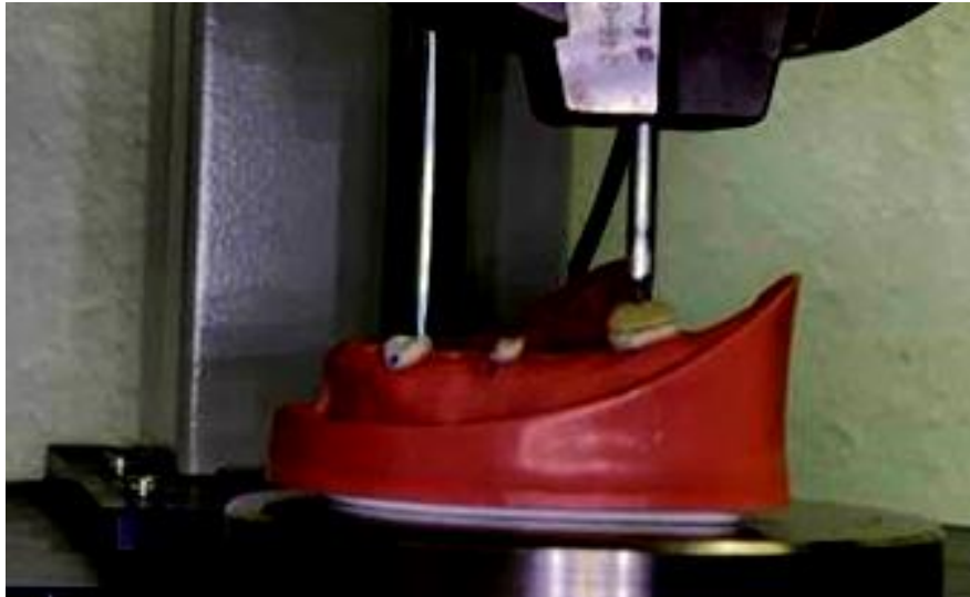
Слика 31. Мастер моделот со PEEK надградба на 35 заб поставен на основа за тест на отпорност на кршење Figure 31. The master model with a PEEK build-up post of no.35 teeth mounted on a base for the Break Resistance Test
