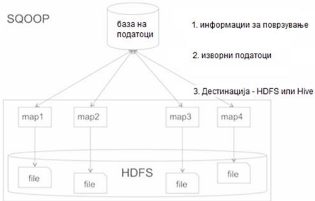
Слика 13. Use Case дијаграм за користење на Sqoop за пресметување на податоци Figure 13. Use Case for using Sqoop to move data into Hive
