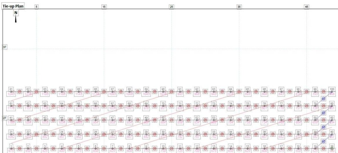
Слика 10. Минска серија со начин на поврзување и иницирање
