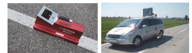
Слика 8. Статички рефлектометар Слика 9. Динамички рефлектометар
