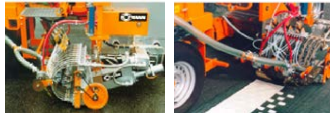
Слика 6. Принцип на нанесување на термопластични ознаки на коловоз (Екструдер)
