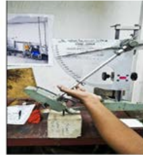
Слика 10. Мерење на отпорот против лизгање на хоризонталните ознаки (‘SRT’ – нишало)
