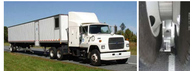
Сл.6: Дефлектометар на тркала во движење (лево) и ласерски сензори поставени помеѓу двојни пневматици (десно) |Извор: лево (7), десно (4)
