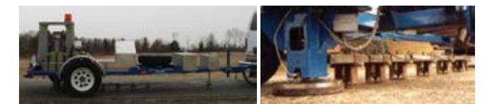
Fig.2: Дефлектометар со тежина во паѓање | Извор: (3)
