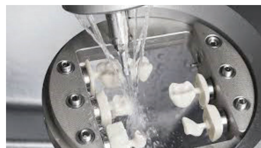
Foto 4. Bloqet për gryrje CAD/CAM dhe procesi i gryrjes Figure 4. Blocks for milling CAD/CAM milling process
