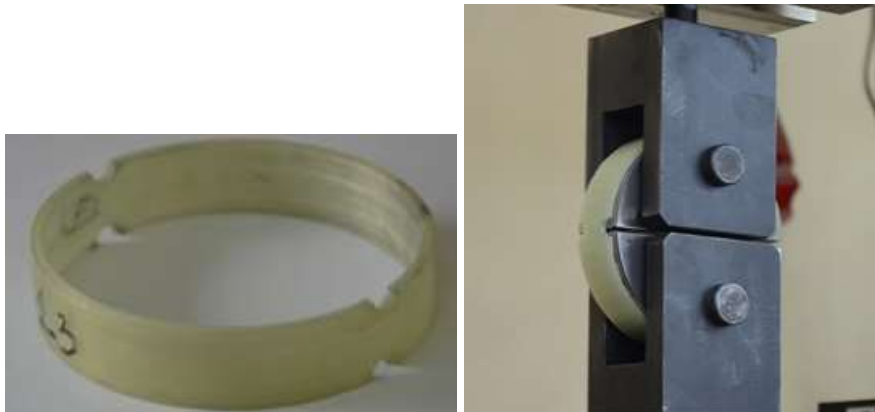
Слика 6.3. Прстен примерок и алат заедно со прстенот за тестирање
