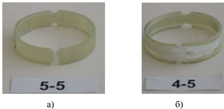
Слика 7.1. Приказ на деструктурирани примероци со различен агол на намотување после испитувањето на јачина на истегнување: а) примерок со најмала јачина на истегнување и агол на намотување 10^0 , б) примерок со најголема јачина на истегнување и агол на намотување 90^0
