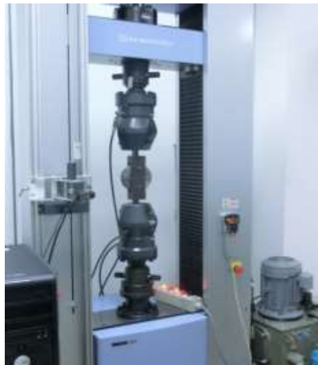
Слика 6.5. Универзална машина за тестирање
