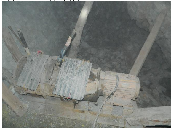
Слика 4. Електричен скрепер за развлекување на засипниот материјал во откопите
