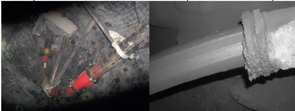
Слика 8. Детали од разводот и одлагањето на пастата во откопите
