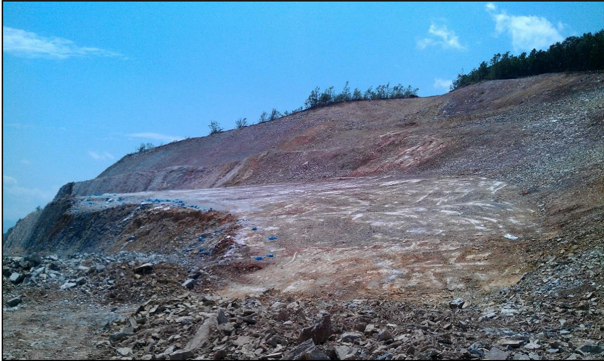
Слика 8.2. Ефекти од минирање на контура со еден до три реда на примарни дупки Figure 8.2. Effects of blasting in case of contour blasting with one to three rows of production drilling
