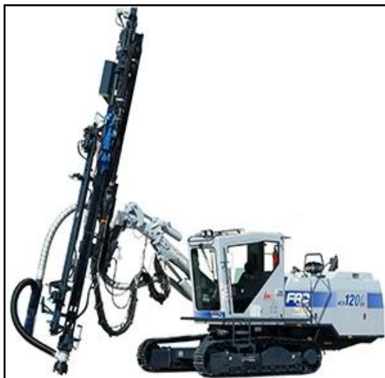
Слика 4.1. Машината за дупчење FURUKAWA HCR 1200 ESII Figure 4.1. The drilling machine FURUKAWA HCR 1200 ESII
