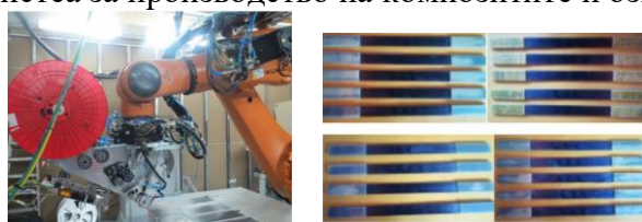
Сл. 5. Производство на композитни ламинати и добиени примероци за тестирање
