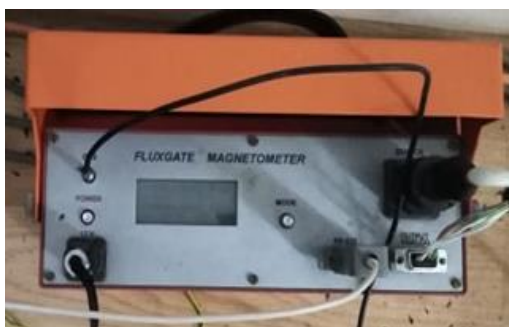
Слика 1.3 Вариометар LEM1 008 и запис на трите компонети од дневната варијација
