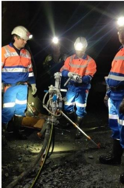
Слика 6. Подготовка и полнење со машинката Can-Blast CB32RM
