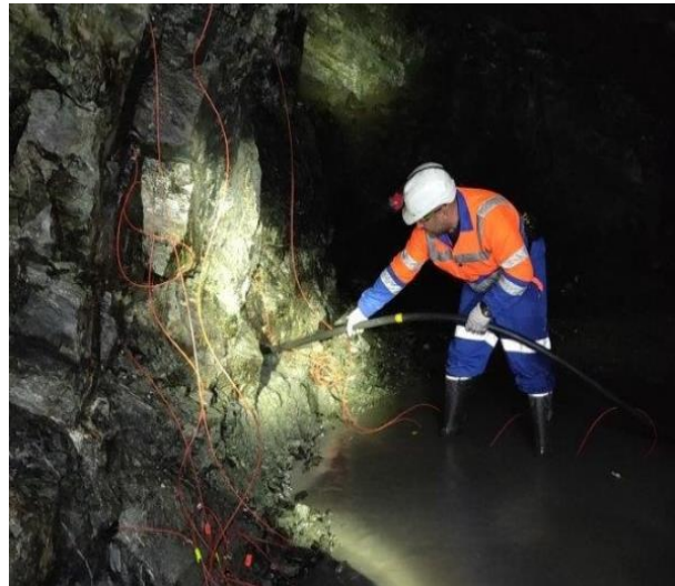
Слика 6. Подготовка и полнење со машинката Can-Blast CB32RM
