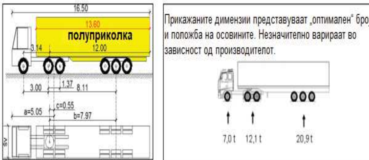
Слика 3. Меродавно возило со полуприколка Извор:[9] A. Deluka-Tibljaš et al, Dodatak D, 2014.
