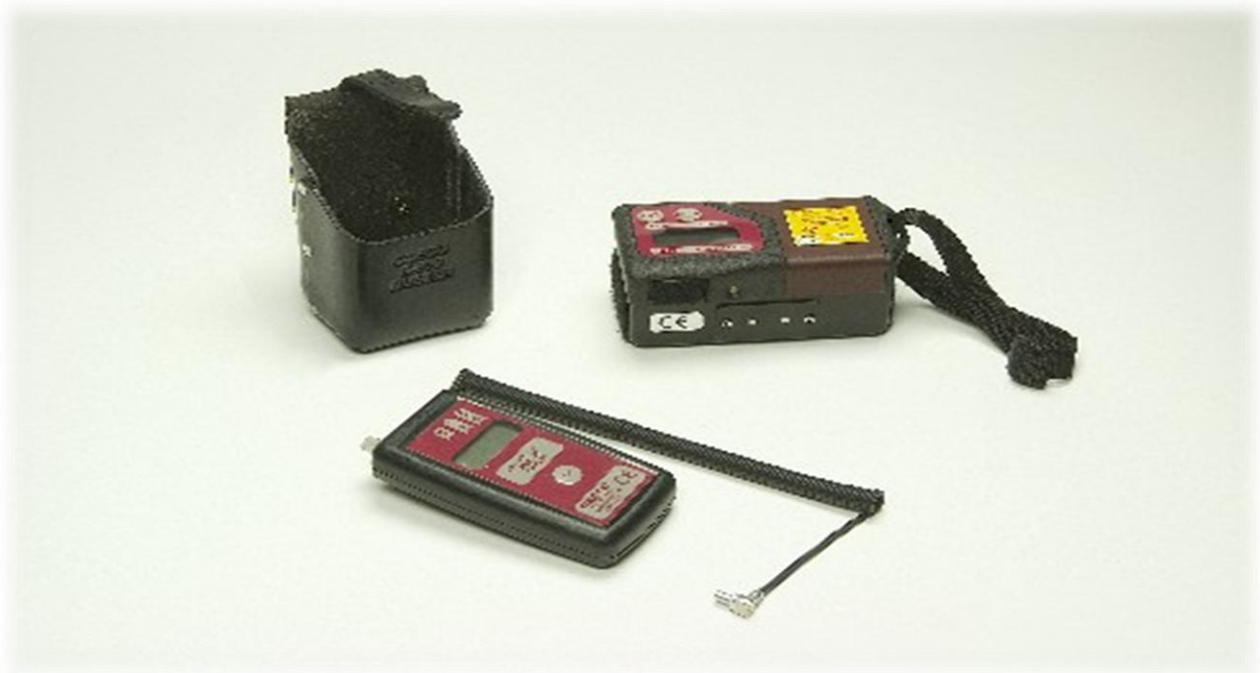
Слика 16: Бастер – детектор за криумчарење
