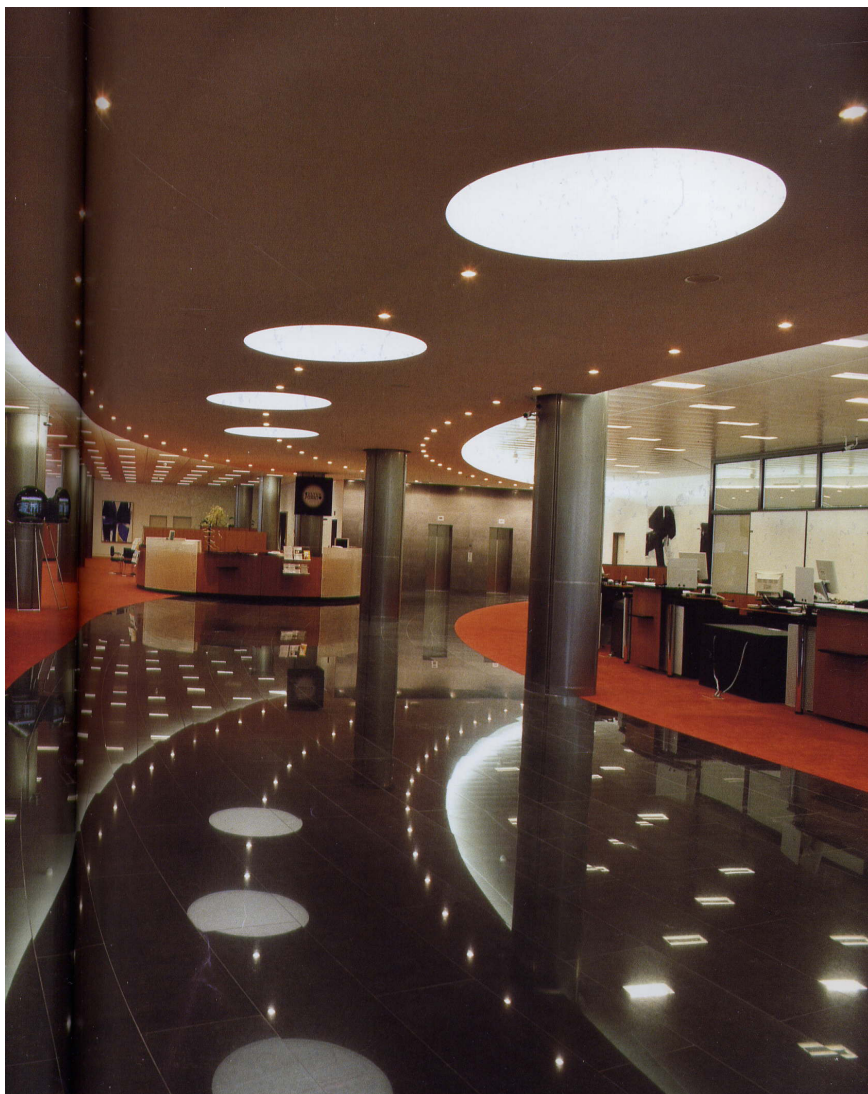
Поради ограничување на ефектот на одблесок, се применуваат светилки кои го намалуваат одблесокот-Kantonalbank, Liestal, Swisse, Targetti, 2001
