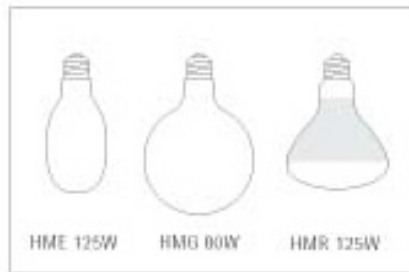
Стандардни живини ламби под висок притисок, елиптична, сферична форма и интегриран рефлектор
