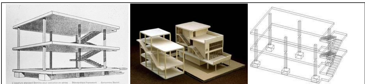
Ле Корбизие- куќата Домино, структурален систем на арм- бетонски столбови и плочи
