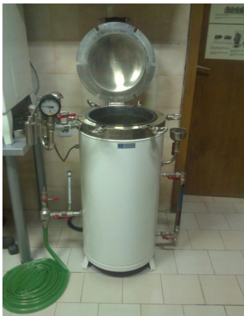
Слика 13. Стерилизација на хранливите подлоги и стакларијата во автоклав Figure 13. Sterilization on mediums and glassware in autoclave
