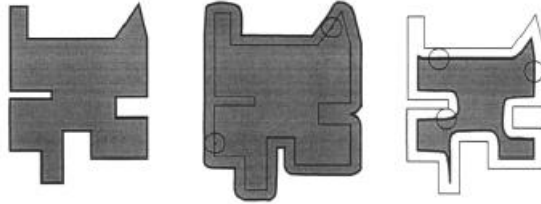
Слика 3: Илустрација на затворање и отворање со SE диск
