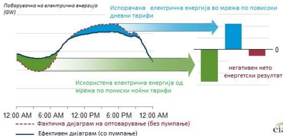
Сл. 2: Дневен 24-часовен дијаграм на производство на ЕЕ со и без користење на ПАХЕ.
