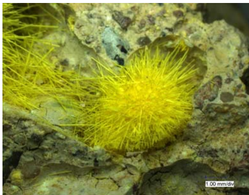
Abb. 2: Aufnahme eines Ettringitbüschels
