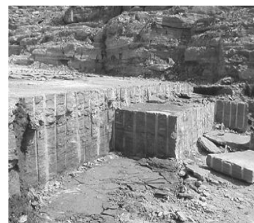
Сл.18 Ефекти од примена на НЕРС при добивање на гранитни блокови
