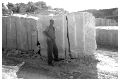
Сл.18 Ефекти од примена на НЕРС при добивање на гранитни блокови
