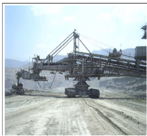
Слика 6.4. Ископ на јаловина а) роторен багер б) претоварен уред Figure 6.4. Soil excavation a) Baskot excavator b) transfer device
