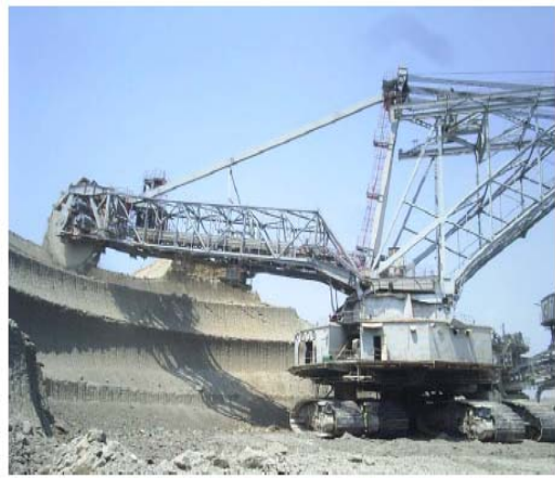
Слика 6.4. Ископ на јаловина а) роторен багер б) претоварен уред Figure 6.4. Soil excavation a) Baskot excavator b) transfer device
