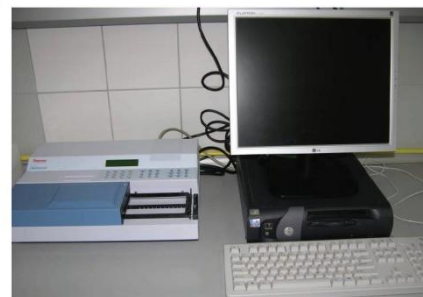
ELISA - комплетен систем составен од хомогенизатор на растително ткиво, промивач и читач за идентификација на вирусните заболувања кај растенијата;
