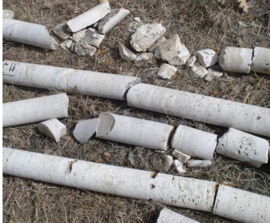
Слика 3. Неуспешно дупчење во наоѓалиште на архитектонско - градежен камен
