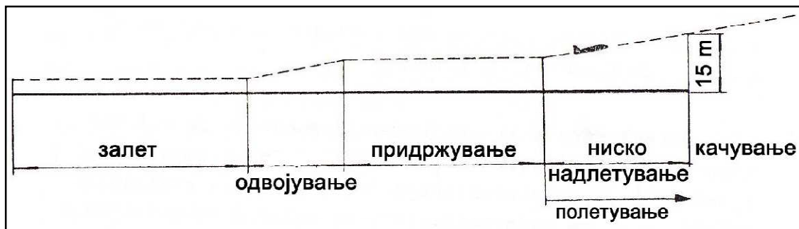
Слика 6: Начин на полетување на воздухоплови со мотори со елиси
