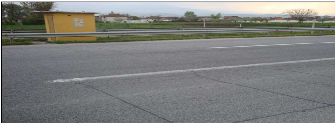
Слика 71: Автоматски бројачи на возила „Sterela“ на патната мрежа, за броење на сообраќајот на патиштата
