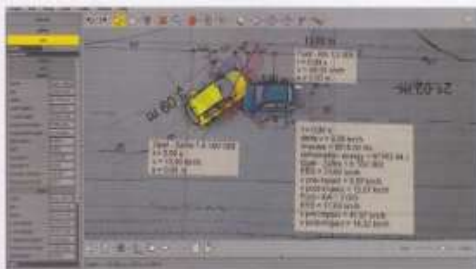
Sl. 5 - Kinetičke vrijednosti dobijene pomoću matematičkog modeliranja sudara
