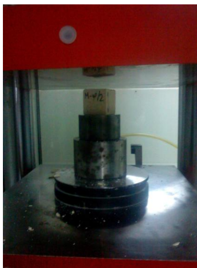
Слика 2. Експериментално испитување: а) уред за испитување на јакост на притисок; б) пробно тело
