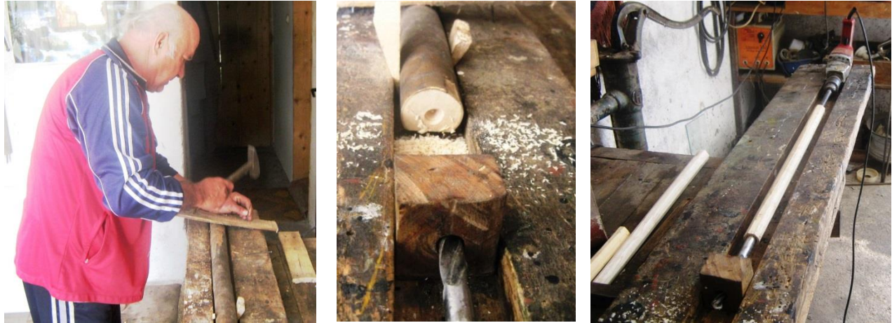
Сл.бр.3. Прицврстување во калап, положба на бургијата и дрвото притегнато со дрвени чивии и делумно изработен инструмент
